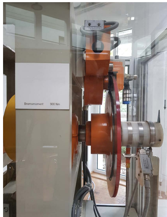
Abb. 15 Durchlaufsicherung (in Form einer Zusatzbremse)
