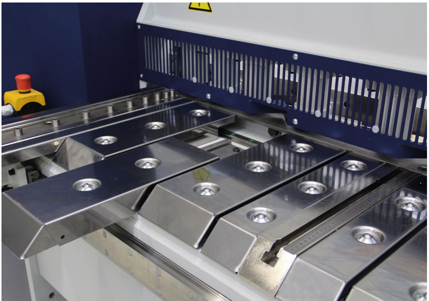
Abb. 2 Auflagen mit Kugelrollen an einer Tafelschere
