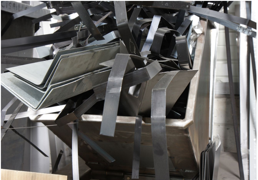
Abb. 1 Aus einem Schrottbehälter heraushängende scharfkantige Blechabschnitte
