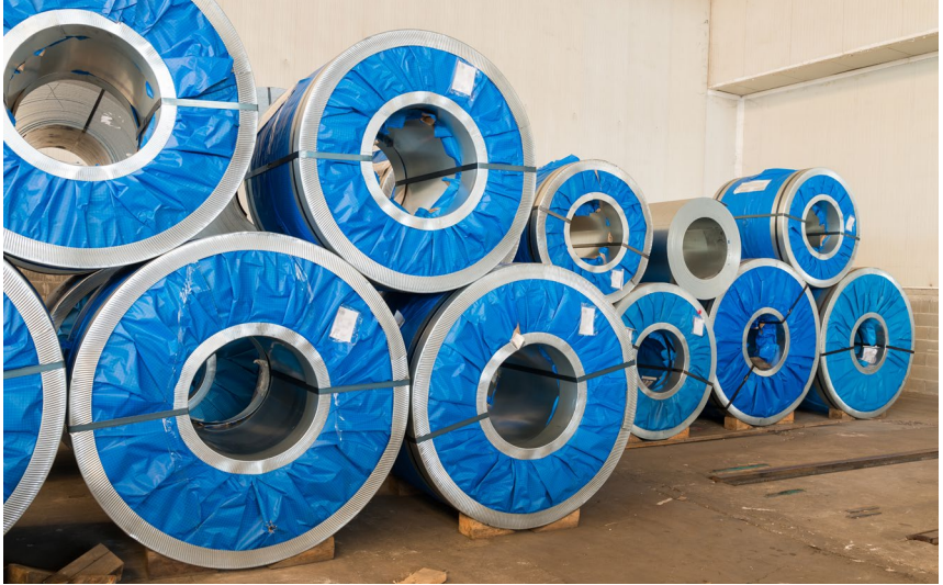
Abb. 20 Beispiel für die Lagerung von Coils mit Stahl-Umreifungsband
