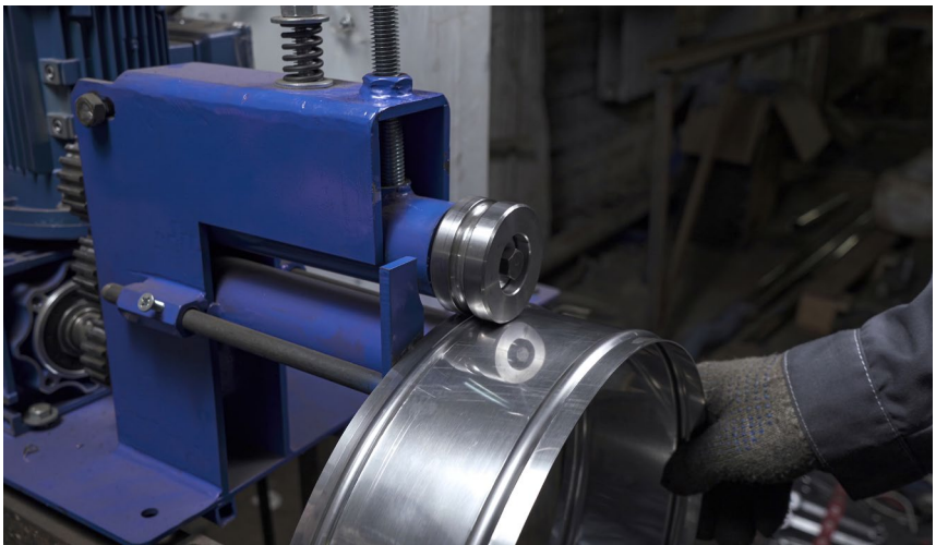
Abb. 49 Beispiel Sicken an einem Blechteil
