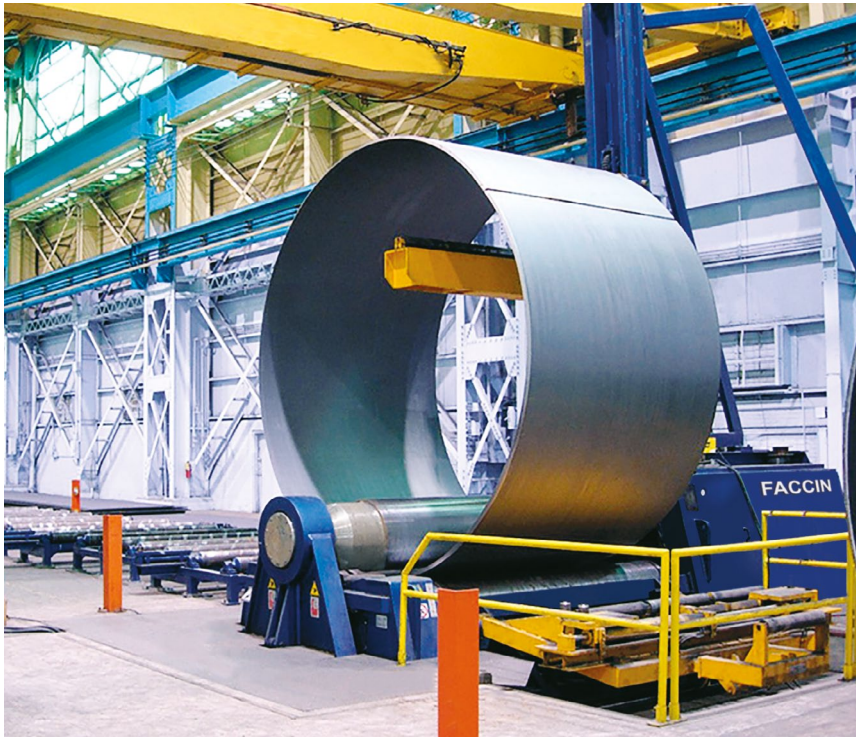
Abb. 41 Beispiel einer Drei-Walzen-Biegemaschine mit Rollenbahn auf der Zuführseite, zentraler Hochhalteeinrichtung und abgesenkter seitlicher Stütze
