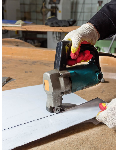
Abb. 24 Elektrische Schere im Einsatz beim Schneiden von Blech in zwei Teile
