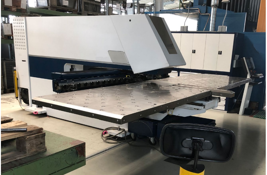
Abb. 31 Stanzmaschine mit umspiegelten Lichtstrahlen als Zugangsschutz. Damit die Bedienperson vom Bedienpult die gegenüberliegende Maschinenseite einsehen kann, wurde ein Zusatzspiegel auf der Lichtstrahlumlenkung installiert.
