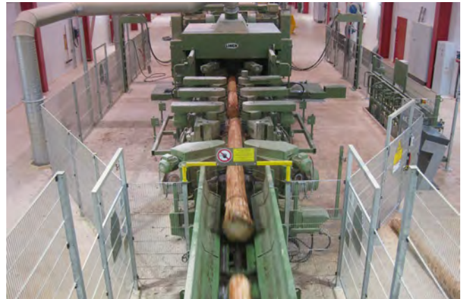
Abb. 15 Einzugs- und Zentriereinrichtung vor dem Spaner und Ventilblöcke außerhalb des Gefahrenbereichs
