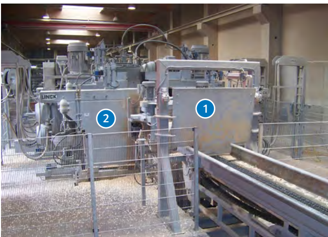
Abb. 13 Eingeschwenkte Rückschlagsicherung vor der Einzugs- und Zentriereinrichtung des Säge-Fräsaggregats als Rückschlagsicherung
