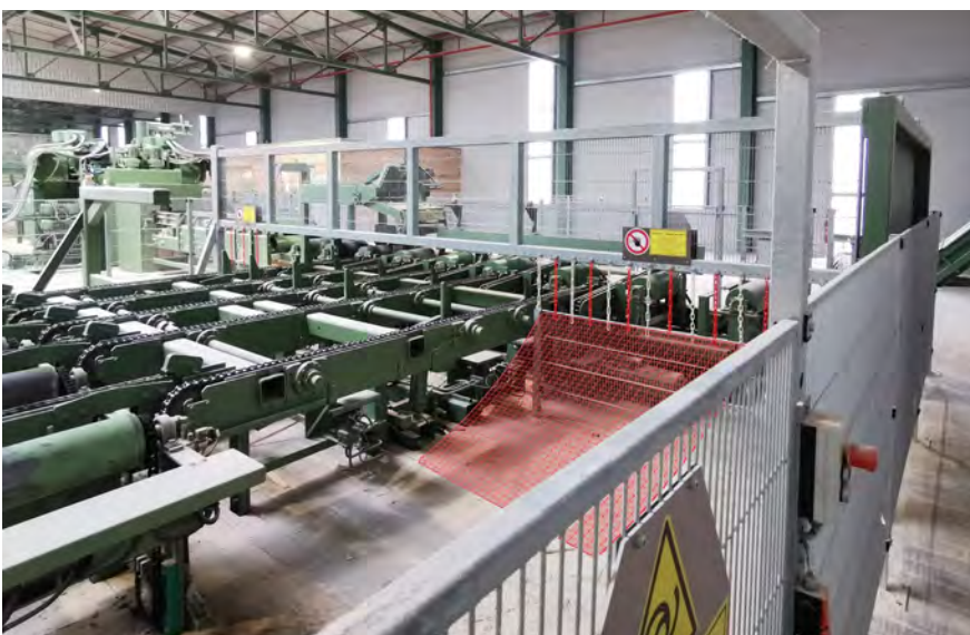
Abb. 4 Schnittstelle zwischen Einschnittlinie und Sortier-Querförderer. Zusätzlich zu dem rot-weißen Kettenvorhang sind weitere sicherheitstechnische Schutzmaßnahmen ggf. nach DIN EN 619 vorzusehen, um ein Übersteigen zu verhindern. Beispielsweise kann ein Stehverhinderer in Form eines gespannten Netzes eingesetzt werden.
