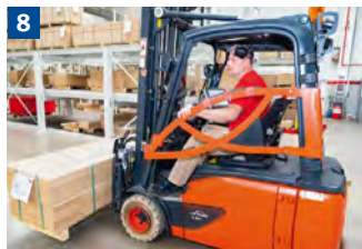
8 Gabelstapler erst verlassen, wenn der Antrieb stillgesetzt, die Feststellbremse angezogen, die Gabeln auf den Boden gesenkt wurde und der Schlüssel gezogen ist.
