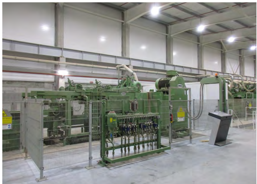
Abb. 1 Stellteile und Bedienpult außerhalb der Gefahrenbereichssicherung.
