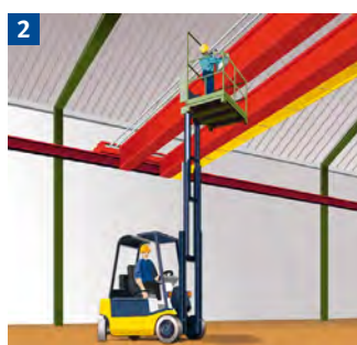
Instandhaltungsarbeiten mit Gabelstapler und Arbeitsbühne
