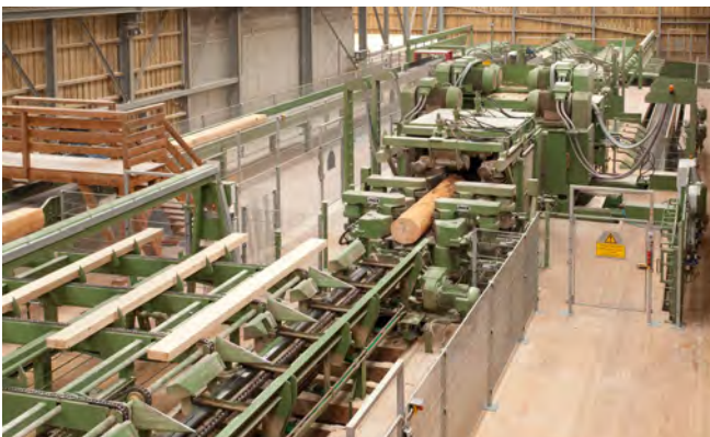
Abb. 27 Zuführung erstes Spanneraggregat
