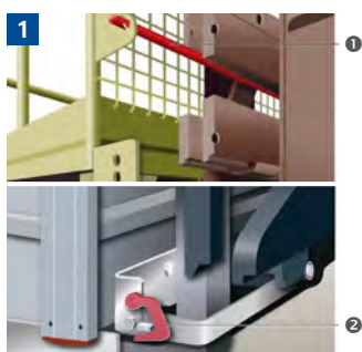
Arbeitsbühne gegen Abkippen und Abrutschen formschlüssig sichern (Steckbolzen ❶ / Sicherheitsbügel ❷).
