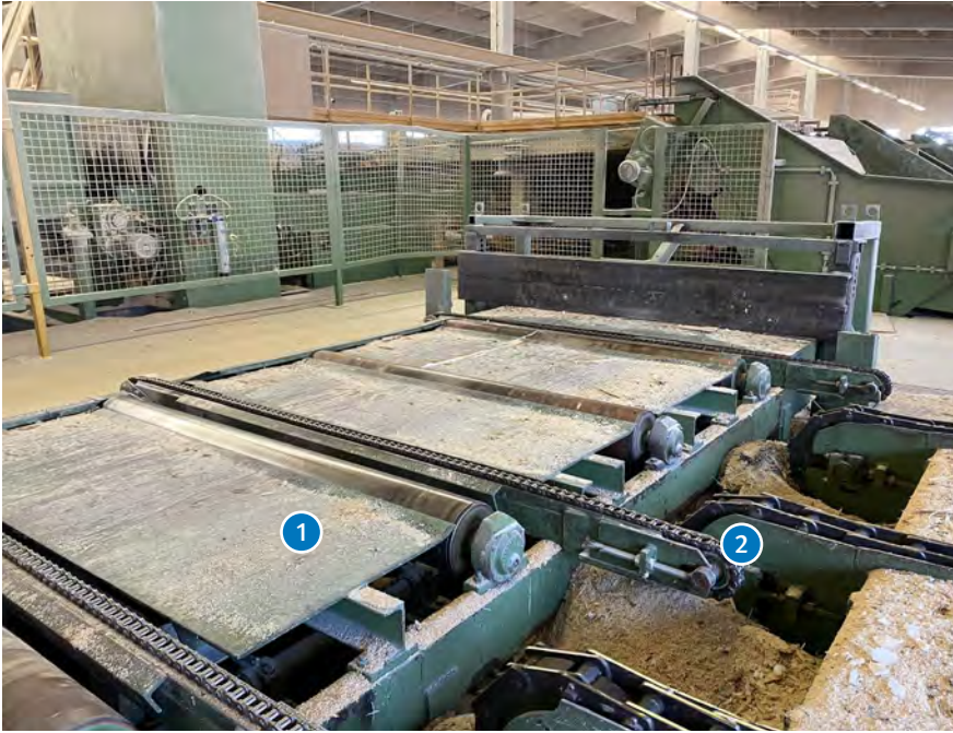
Abb. 44 Querförderer als Winkelübergabe im Abzugsrollengang (untere Endstellung)
