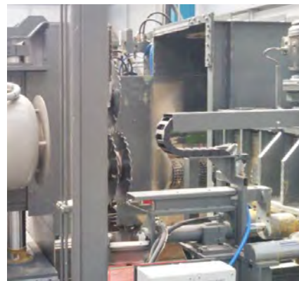
Abb. 28 Mehrblattkreissäge im Wartungszustand
