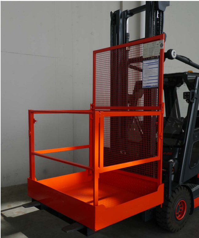
Abb. 10 Arbeitsbühne am Gabelstapler
