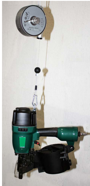
Abb. 29 Eintreibgerät mit Balancer
