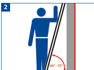
Anlegeleitern im richtigen Winkel (65° – 75°) anlegen.
