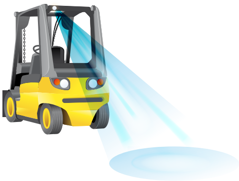
Abb. 37 Flurförderzeug mit optischer Fahrweg-Warneinrichtung
