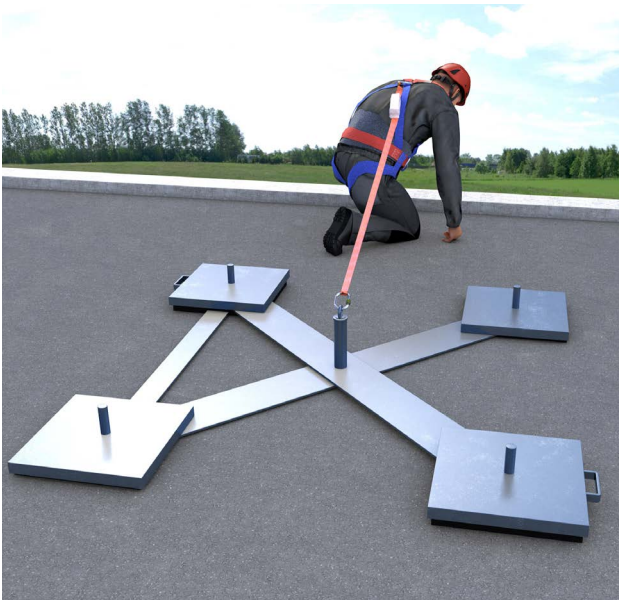
Abb. 20 Beispiel für eine durch Eigengewicht gehaltene Anschlagvorrichtung gemäß Typ E DIN EN 795
