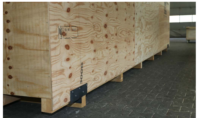
Abb. 48 Anschlagpunkte an der Exportverpackung
