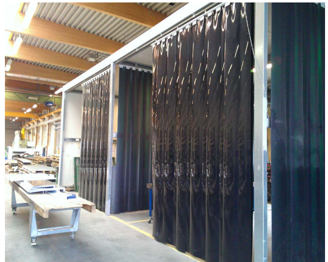
Abb. 36 Montagekabine mit Schutzwand
