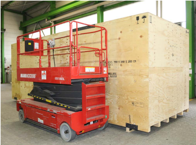
Abb. 7 Fahrbare Hubarbeitsbühne an einer Exportverpackung
