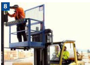
Instandhaltungsarbeiten mit Gabelstapler und Arbeitsbühne
