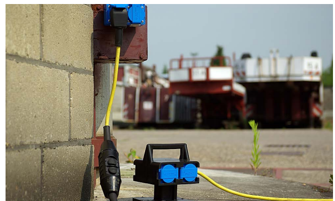
Abb. 45 Schutzverteiler mit vier Steckdosen
