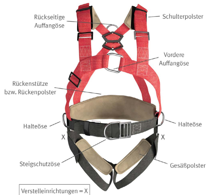
Abb. 6 Beispiel eines Auffanggurts mit vorderer und rückseitiger Auffangöse, seitlichen Halteösen und einer Steigschutzöse. Der Gurt ist zusätzlich mit Schulter-, Bein- und Rückenpolstern ausgestattet.
